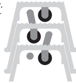
entgegengesetzte Richtung, so, dass die Seile im Profil der zweiten Sprosse liegen (siehe Zeichnung). Verfahren Sie so weiter, bis alle Sprossen wie Sattel über Sattel aufeinanderliegen. Drücken Sie nun den Sprossenstapel fest zusammen, und streifen Sie die Halteklammer über die Sprossen. Fertig!
